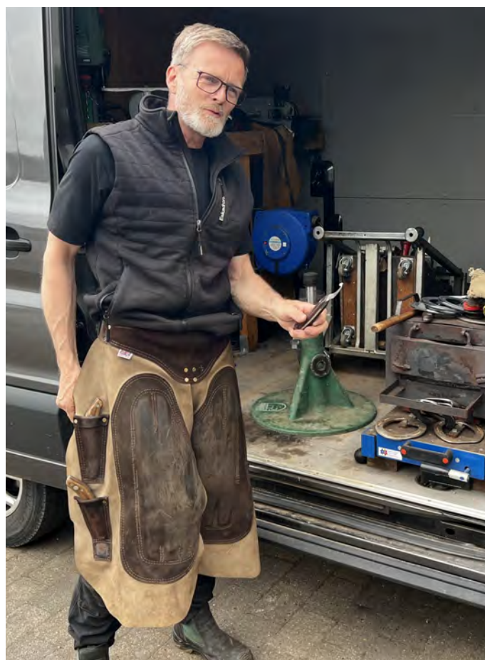
Beslagsmedens bil er et mobilt smedeværksted, der rummer både ild, ambolt, værktøj og et skolager af standardsko. Det er dog ikke alle sko, der kan tilpasses, for ligesom mennesker kan heste have brug for ortopædisk fodtøj, der kræver 'skræddersmedede' sko. Fotos: Per Hammel
